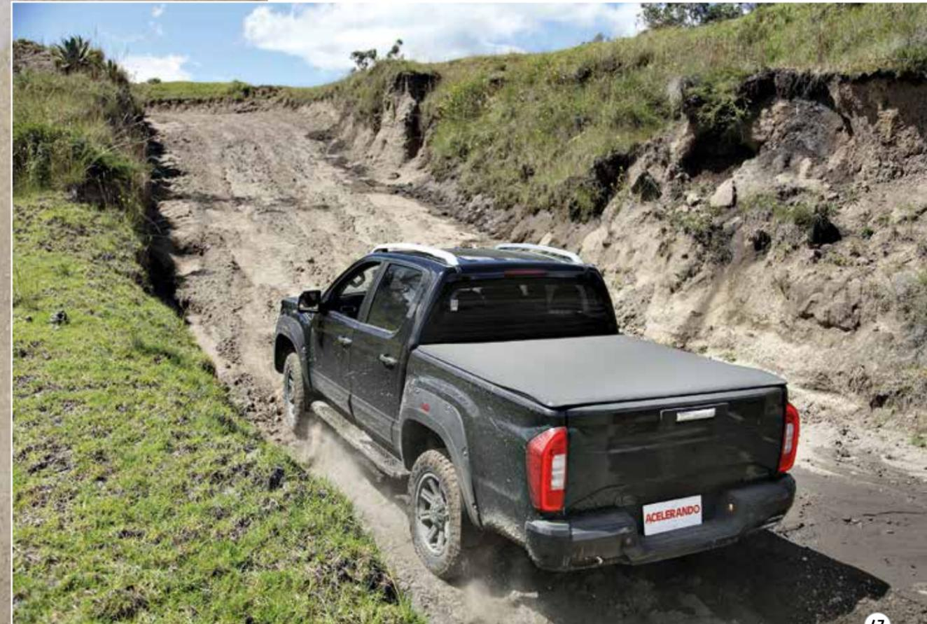
**POTENCIA Y TECNOLOGÍA OFF-ROAD. MOTOR 2.0L CD DSL CON 160 HP Y 390 NM DE TORQUE + TRANSMISIÓN 8 VELOCIDADES (AT) O 6 VELOCIDADES (MT). SUSPENSIÓN REFORZADA (BALLESTAS TRASERAS/DOBLE HORQUILLA DELANTERA) Y LLANTAS 265/60 R18 PARA TODO TERRENO.**
